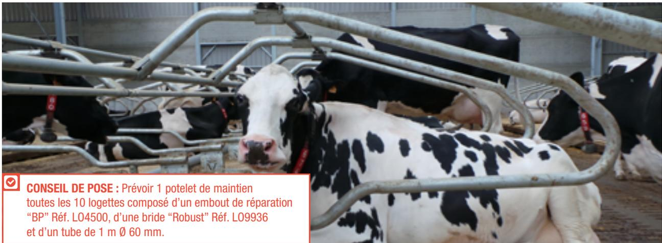
**CONSEIL DE POSE :** Prévoir 1 potelet de maintien toutes les 10 logettes composé d'un embout de réparation "BP" Réf. L04500, d'une bride "Robust" Réf. L09936 et d'un tube de 1 m Ø 60 mm.
